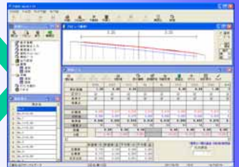
横断データ画面 計画値や切削値の修正を行います。 車線区切りや摺り付け指定を行います。
